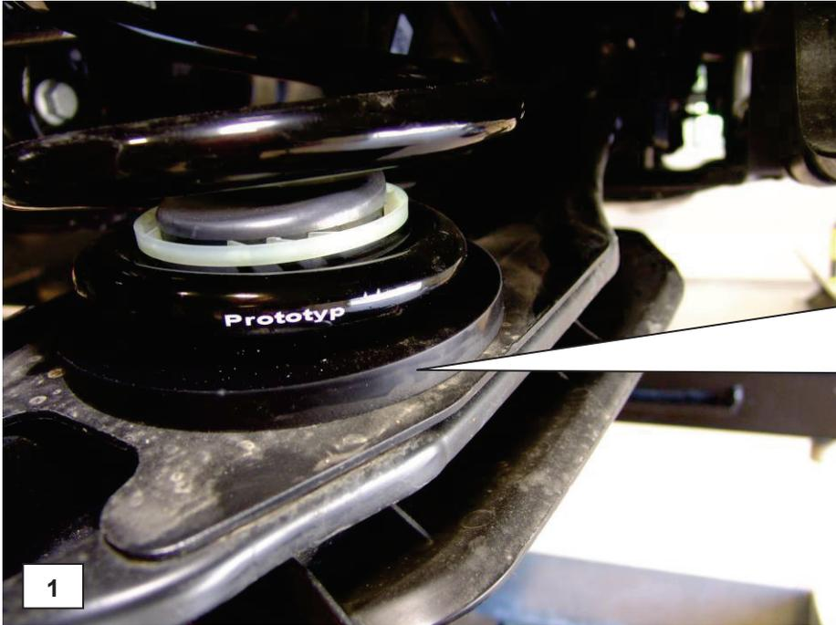
Der mitgelieferte Feder-teller M45-85-052-01-01 wird an der Hinterachse unten angebracht.
