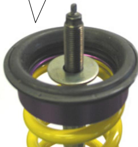
Federbein mit montiertem Stützlager. Anzugsdrehmoment der Kolbenstangenverschraubung 60Nm.
