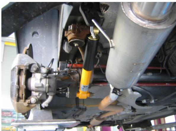
Der Einbau der HA-Stoßdämpfer erfolgt gemäß Werkstatthandbuch. Sofern im Lieferumfang kein Anschlagpuffer enthalten ist wird das Serienmäßige in ungekürzter Ausführung weiterverwendet. Dieses muss sich in einwandfreiem Zustand befinden und ist ggf. zu erneuern.
