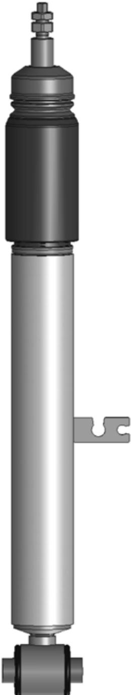
Original Stützlager auf den Dämpfer aufsetzen und mit den mitgelieferten Muttern verschrauben. Das Anzugsdrehmoment der Kolbenstangenbefestigung beträgt 20 Nm. Zusätzlich muss die Original Dichtung und die Abdeckung wieder montiert werden.
