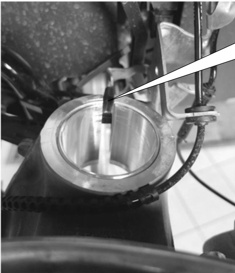
Beim Einbau der mitgelieferten Distanzhülse muss darauf geachtet werden, dass der Spannschlitz der Distanzhülse exakt mit dem Spannschlitz des Radnabengehäuses übereinstimmt.
