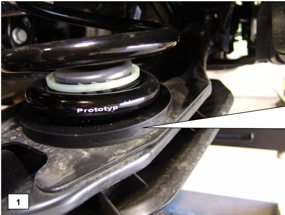
Der mitgelieferte Feder-teller M45-85-062-01-01 wird an der Hinterachse unten angebracht.
