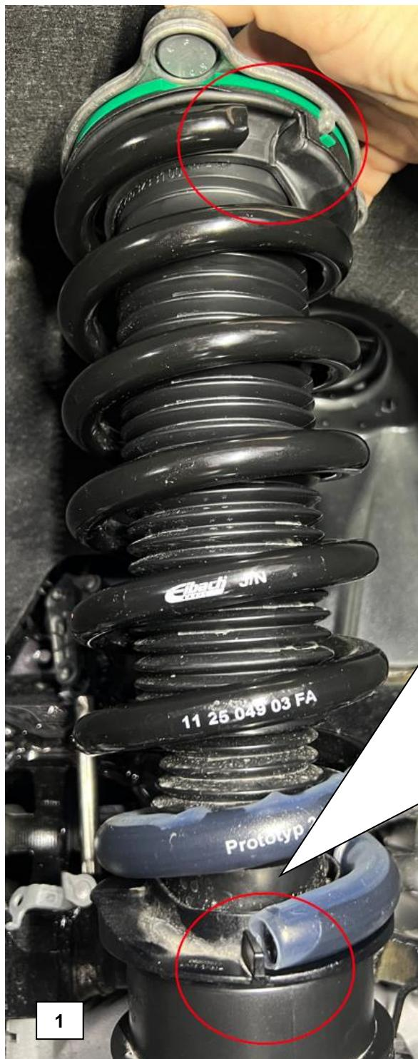
Die serienmäßigen Federanbringungen unten, an Vorder- und Hinterachse müssen ggf. (in Abhängigkeit von der Federwindungszahl) so positioniert bzw. gedreht werden, sodass die Teller einer Anschlagfunktion nachkommen und ein Verdrehen der Feder ausgeschlossen werden kann (ein Spiel von ca. 5mm zwischen dem jeweiligen Federende und den Anschlägen der Federanbringungen sind zulässig).
