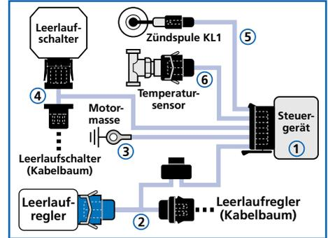
Der TR2-Kabelbaum darf nicht z.B. durch heiße Gase oder scharfe Kanten beschädigt werden.
