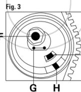
FIGURA 3 Aflojar el tornillo de fijación F. Actuando en el punto indicado G del tensor, alinear la marca de fase I con la marca H. Por último, apretar el tornillo de fijación F.
