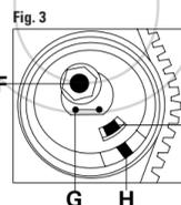
FIGURA 3 Allentare il bullone di bloccaggio F, agendo nel punto indicato G del tenditore, ed allineare la tacca di fase I con quella H; serrare, quindi, il bullone di bloccaggio F.
