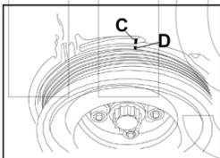
Figura 2: Il riferimento C sul carter della cinghia deve essere allineato con il riferimento D sulla puleggia albero motore.
