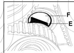
Figura 3: Controlar que el soporte del tensor E está bien posicionado en el alojamiento F de la culata.
