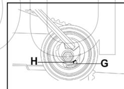
Figura 4: Ruotare il tenditore in senso orario e portare l'indicatore mobile nella posizione di massima tensione. Ruotare il tenditore in senso antiorario e rilasciare la cinghia. Ruotare il tenditore in senso orario e allineare l'indicatore mobile G con la tacca H. Serrare il dado del tenditore.
