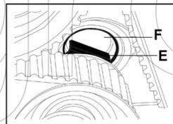
Figura 3: Verificare il corretto posizionamento della staffa del tenditore E nella sede F sulla testata.
