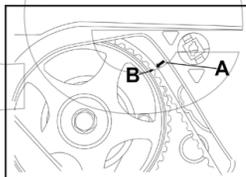
Figura 1: Il riferimento A sul carter posteriore della cinghia deve essere allineato con il riferimento B sulla puleggia albero a camme.
