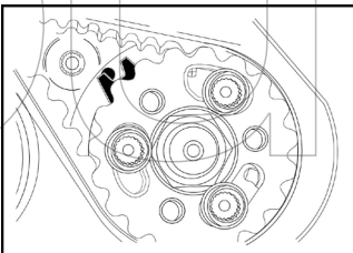
Figura 4: Girar el cigüeñal dos vueltas en sentido horario y volver a insertar las distintas herramientas para controlar que la sincronización es correcta. Si no se pudiese insertar la plantilla de la bomba alta, controlar que la desviación sea leve.
