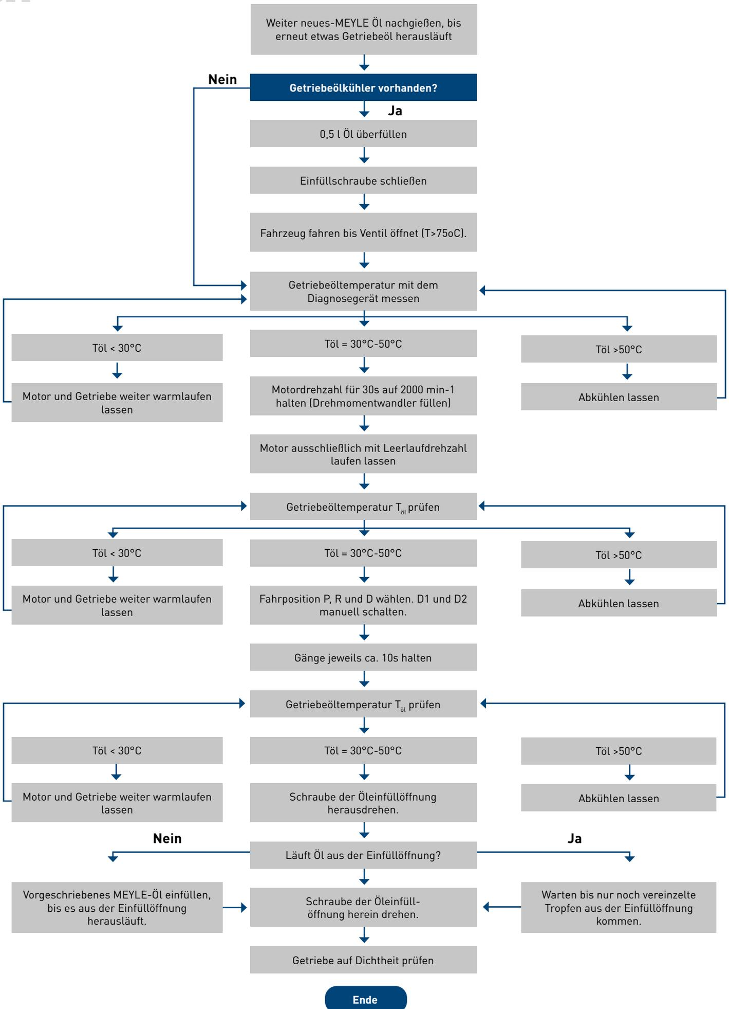
**Achtung:** Bei diversen Getriebetypen kann ein Bypassventil verbaut sein, welches den Ölkreislauf zum Ölkühler öffnet oder verschließt. Deshalb sollte bei einer ausreichenden Probefahrt die Getriebeöltemperatur mindestens 75 °C erreichen. Nach der Probefahrt das Getriebe abkühlen lassen und den Ölstand erneut kontrollieren ggf. korrigieren.
