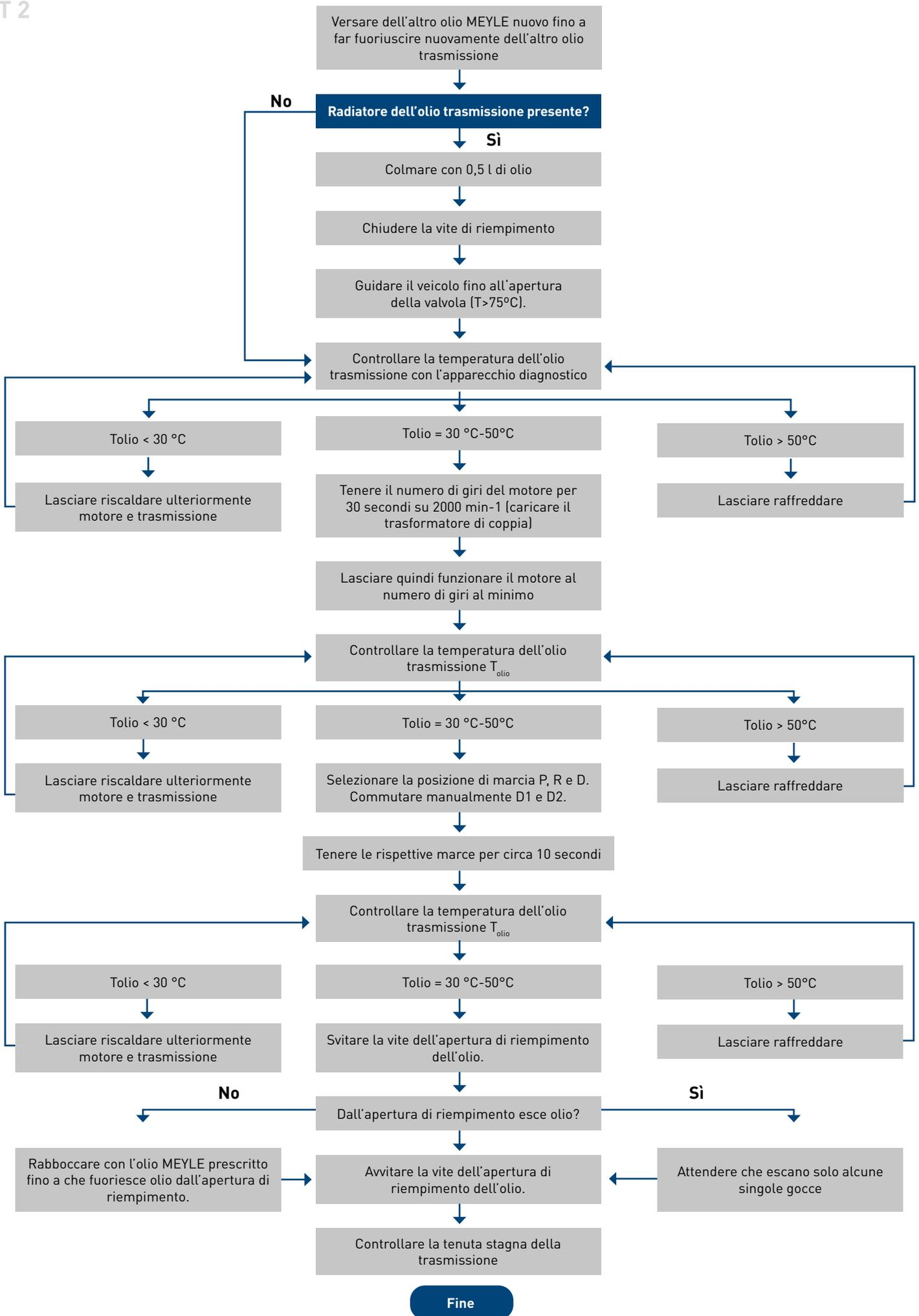
**Attenzione:** in diversi tipi di trasmissioni può essere montata una valvola bypass che apre o chiude il circuito dell'olio verso il radiatore dell'olio. Per questo, la temperatura dell'olio trasmissione dovrebbe raggiungere almeno una temperatura di  $75^{\circ}\text{C}$  in un giro di prova sufficiente. Dopo il giro di prova, lasciare raffreddare la trasmissione, controllare nuovamente il livello dell'olio ed eventualmente correggerlo.
