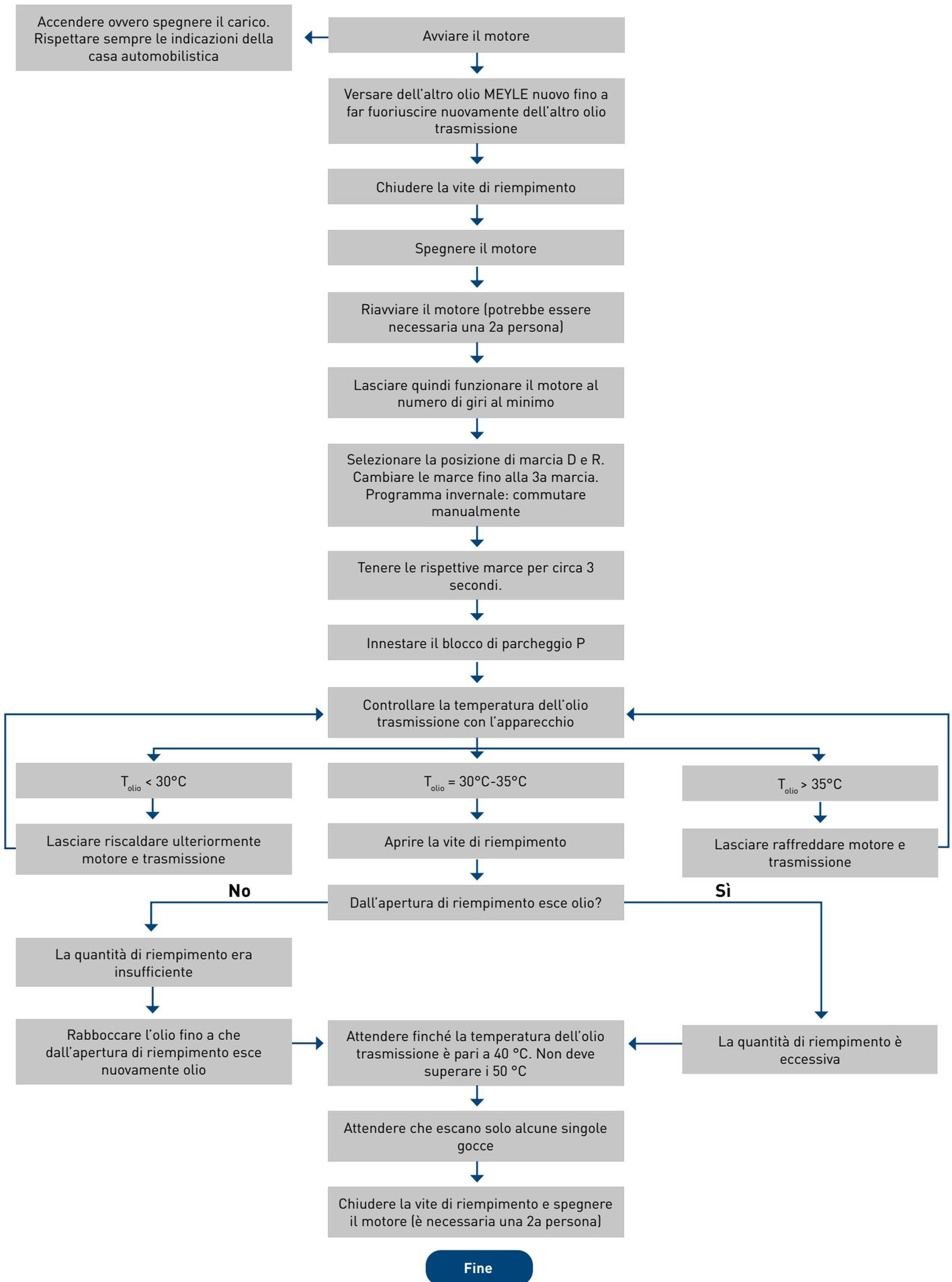
**Attenzione:** in diversi tipi di trasmissioni può essere montata una valvola bypass che apre o chiude il circuito dell'olio verso il radiatore dell'olio. Per questo, la temperatura dell'olio trasmissione dovrebbe raggiungere almeno una temperatura di  $75^{\circ}\text{C}$  in un giro di prova sufficiente. Dopo il giro di prova, lasciare raffreddare la trasmissione, controllare nuovamente il livello dell'olio ed eventualmente correggerlo.
