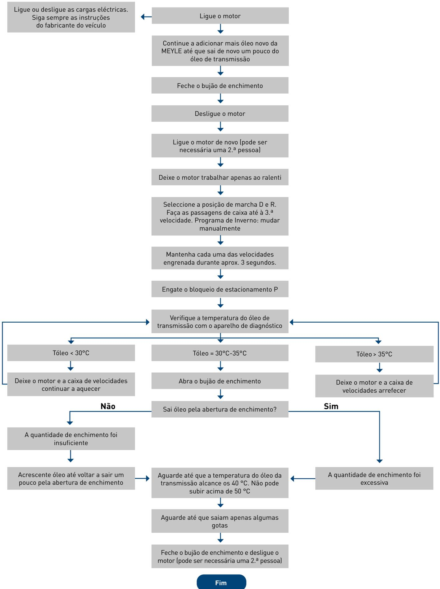
**Atenção:** em diversos tipos de caixas de velocidades pode estar montada uma válvula de bypass, que abre ou fecha o circuito de óleo para o radiador de óleo. Em função disso, a temperatura do óleo de transmissão deverá atingir, pelo menos, os 75 °C durante um teste drive suficientemente longo. Após o test drive, deixe a caixa de velocidades arrefecer, verifique novamente o nível de óleo e, se necessário, acrescente óleo.
