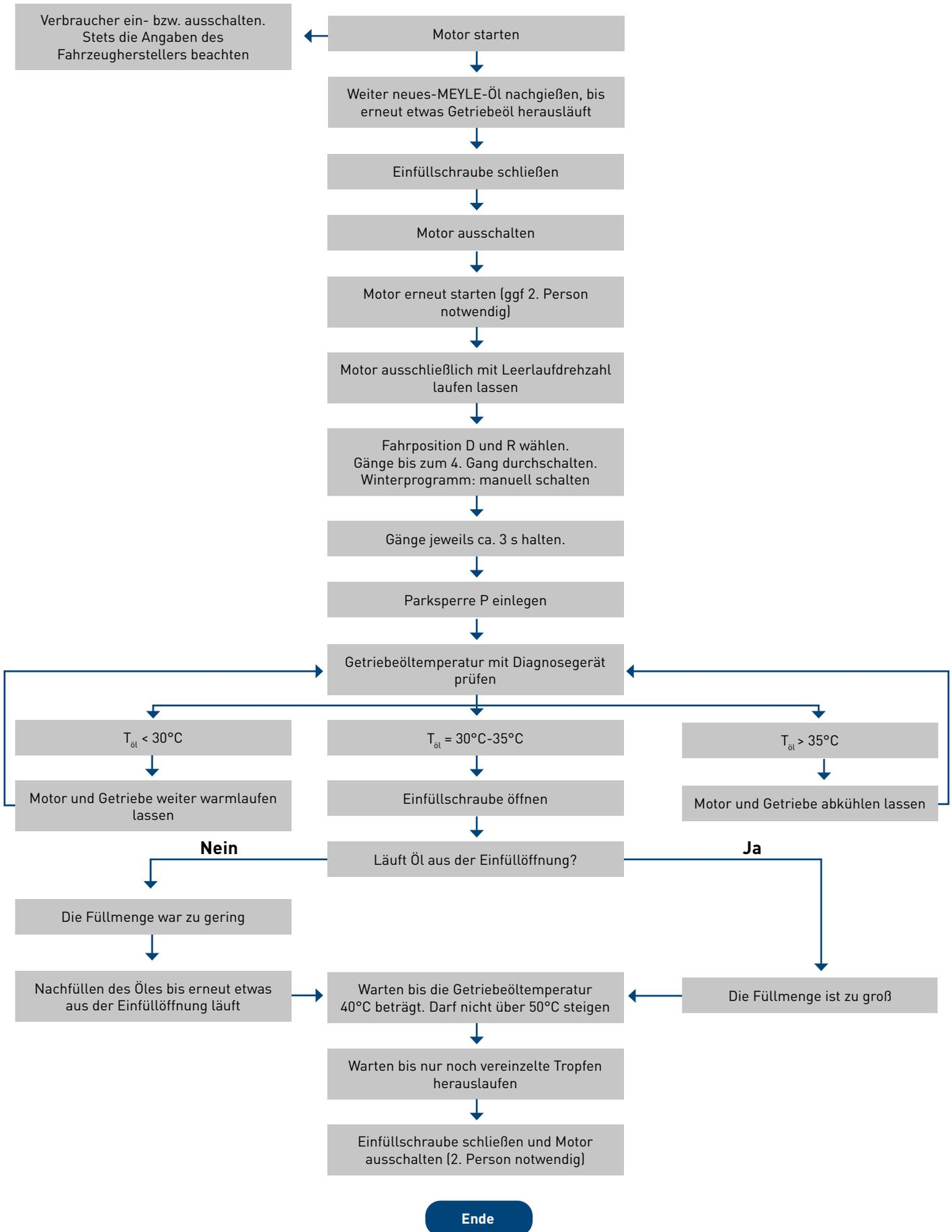
**Achtung:** Bei diversen Getriebetypen kann ein Bypassventil verbaut sein, welches den Ölkreislauf zum Ölkühler öffnet oder verschließt. Deshalb sollte bei einer ausreichenden Probefahrt die Getriebeöltemperatur mindestens 75 °C erreichen. Nach der Probefahrt das Getriebe abkühlen lassen und den Ölstand erneut kontrollieren ggf. korrigieren.
