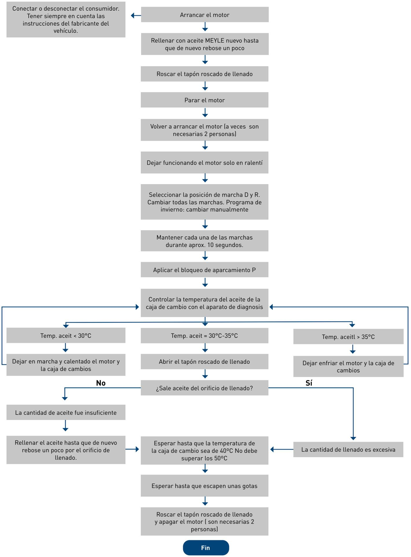
**Atención:** En diversos tipos de cajas de cambio puede estar montada una válvula de bypass, la cual abre o cierra el circuito de aceite al enfriador de aceite. Por ello, con una prueba de marcha suficiente la temperatura del aceite de la caja de cambios deberá alcanzar mín. 75°C. Después de la prueba de marcha dejar enfriar la caja de cambios y controlar de nuevo o corregir el nivel del aceite.
