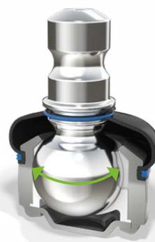
**MEYLE-HD-Querlenker für Mercedes-Benz W205: Vergrößerter Kugelbolzen verringert Flächenpressung und Verschleiß.**
