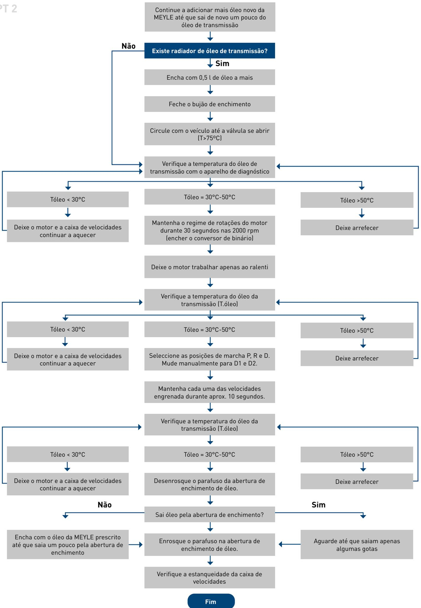
**Atenção:** em diversos tipos de caixas de velocidades pode estar montada uma válvula de bypass, que abre ou fecha o circuito de óleo para o radiador de óleo. Em função disso, a temperatura do óleo de transmissão deverá atingir, pelo menos, os 75 °C durante um teste drive suficientemente longo. Após o test drive, deixe a caixa de velocidades arrefecer, verifique novamente o nível de óleo e, se necessário, acrescente óleo.
