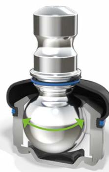
Bras de suspension MEYLE-HD pour Mercedes-Benz W205 : l'élargissement du pivot sphérique réduit la pression de la surface et l'usure.
