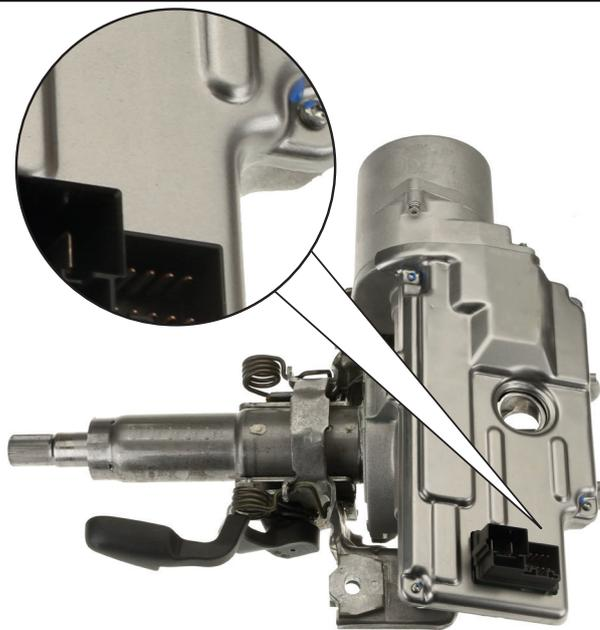
*Coluna da direção sem conexão do sensor externa*
