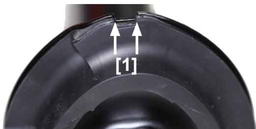
Alinhar o entalhe no amortecedor com o entalhe do apoio em borracha [1]
