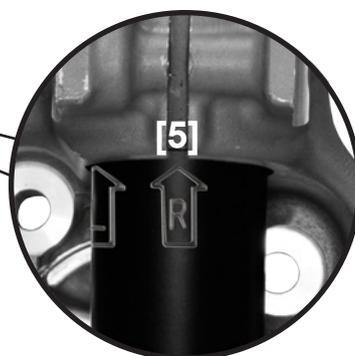
Encaixe do eixo direito: Montar o amortecedor de modo que a seta “R” fique alinhada com o entalhe [5].
