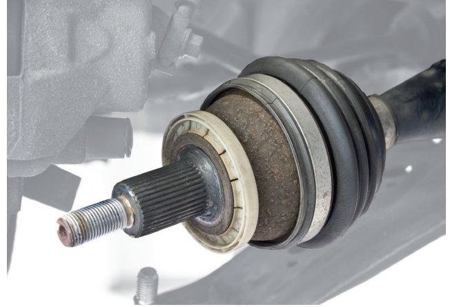
Şekil 1: Sızdırmazlık keçelerinin tasarım ve rengi uygulamaya göre değişiklik gösterebilir.
