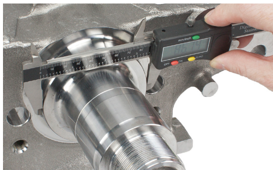
Slika 2: Za odabir odgovarajućeg rezervnog dijela potrebno je utvrditi nazivni promjer sjedišta brtvenog dijela prstena na osovinskom rukavcu
