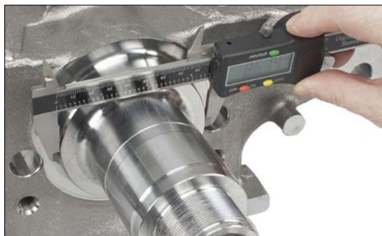
Slika 2: Izmerite osnovo premnika, in tako določite, katerega izmed treh obročkov je treba namestiti.
