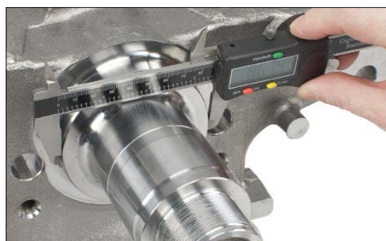
Slika 2: Da biste utvrdili koji od tri prstena da montirate, bazna površina rukavca točka mora biti izmerena
