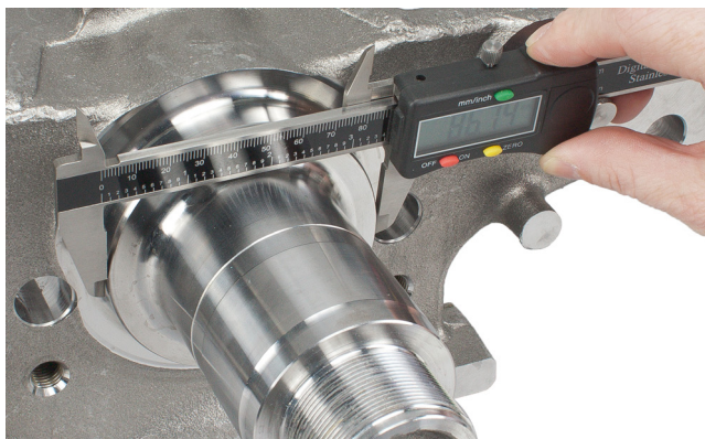
Bild 2: För att kunna bestämma vilken av tre skyddsringar som är den rätta, måste diametern på tätningens säte mätas
