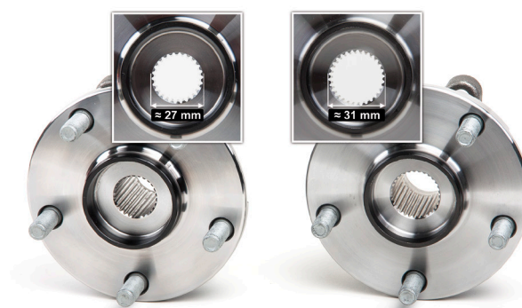
Εικόνα 2: Η διάμετρος της οδόντωσης μπιλιοφόρου είναι διαφορετική
