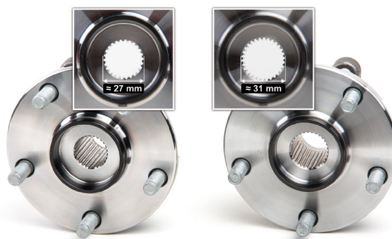
Рисунок 2: Разный диаметр шлицев ШРУСа.
