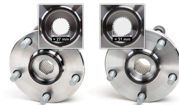
Зображення 2: Діаметр шліцьового з'єднання приводного вала є різним
