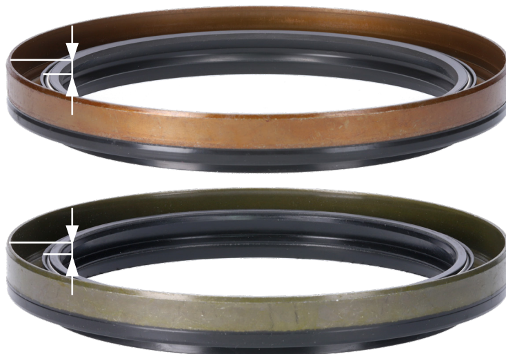
Fig. 2: O lábio obturador do retentor fornecido (em cima) apenas é ligeiramente diferente da versão original instalada (em baixo).
