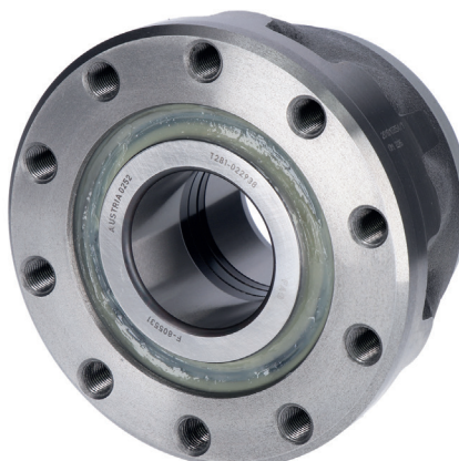
Afbeelding 2: Het onderdeel nr. 805532.03.H195 heeft geen afdichting. Dit wordt gedaan door de naafdop.
