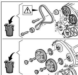
Für den Austausch der defekten Nockenwellenversteller muss der Zahnriemen ausgebaut werden. Da dieser einem Wechselintervall unterliegt, ist es aus wirtschaftlicher Sicht meist sinnvoll, den kompletten Zahnriementrieb samt Spann- & Umlenkrollen sowie der Wasserpumpe ebenfalls zu ersetzen. Bei Ölaustritt ist der Zahnriementrieb zwingend zu ersetzen!
