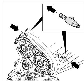
Um einen einwandfreien Betrieb der neuen Nockenwellenversteller zu gewährleisten, müssen die im INA Engine KIT enthaltenen Steuerventile verwendet werden.
