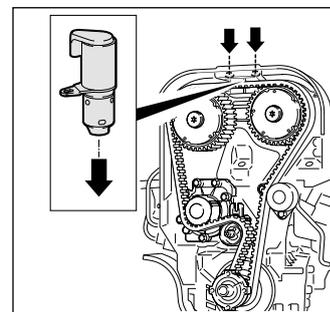
Aufgrund von Verschmutzungen und Abrieb setzen sich die Filter der Steuerventile zu. Dadurch werden die Nockenwellenversteller nur noch unzureichend mit Motoröl versorgt und irreparabel beschädigt. Diese Beschädigung macht sich durch eine deutliche Geräusentwicklung und/oder Ölaustritt bemerkbar.
