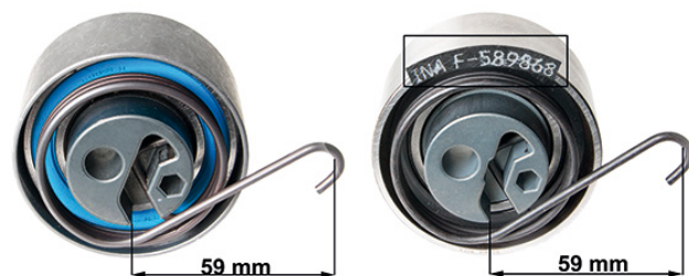
Рисунок 2: 531 0819 10 - прежняя конструкция (слева), новая конструкция (справа)
