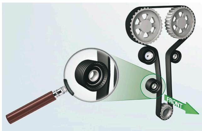
Рисунок 1: Траектория ремня и позиция ролика на двигателе F4R
