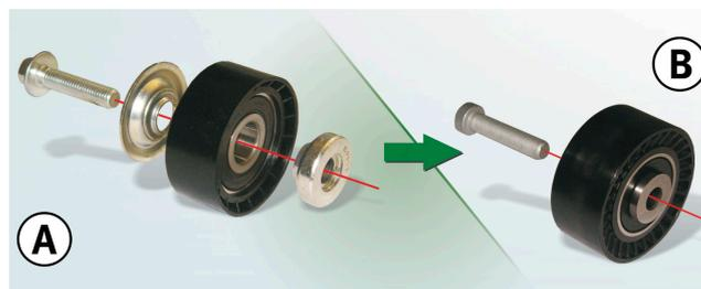
Обводной ролик 532 0433 10, предыдущая конструкция (А) и новая (В)
