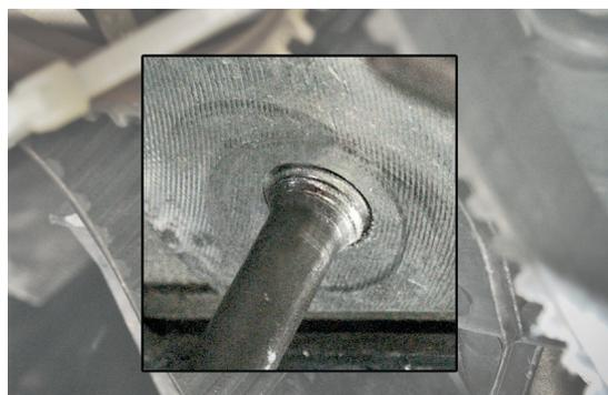
Figura 1: Il perno non è avvitato correttamente
