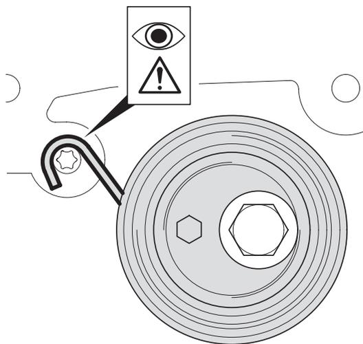
Fig. 1: Posición de montaje correcta del resorte del perno de fijación
