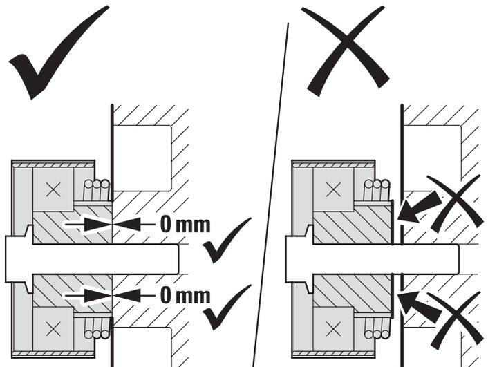
Fig. 2: Izquierda: la polea tensora está montada asentada en toda la superficie de apoyo del motor.
