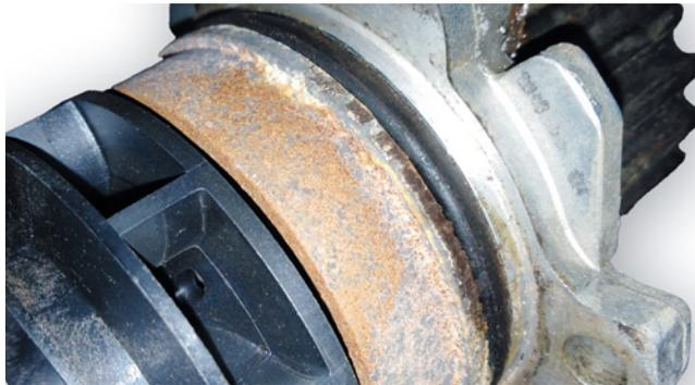
Imagem 1: Vestígios de corrosão em uma bomba de refrigerante
