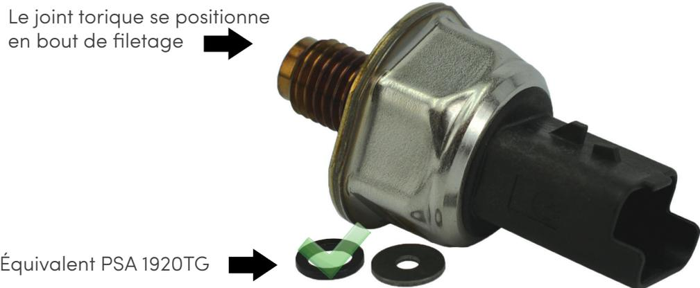
Avant le montage, vérifiez la présence d'une rondelle dans la rampe d'injection : si une rondelle est déjà en place, remplacez-la impérativement par celle fournie dans la boîte avec le capteur. En revanche, si aucune rondelle n'est présente, n'ajoutez pas celle fournie.
