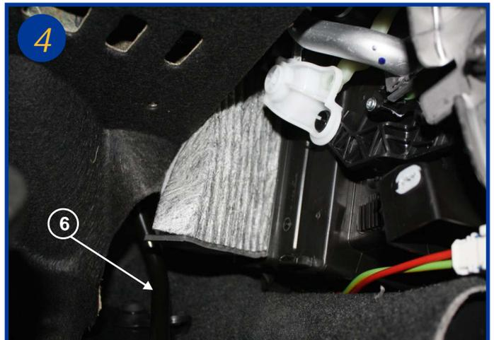
Extraire l'élément filtrant usagé et procéder à son remplacement, il est nécessaire de garder appuyé la pédale d'accélérateur pour retirer le filtre (6). Le remontage s'effectue dans l'ordre inverse du démontage.
