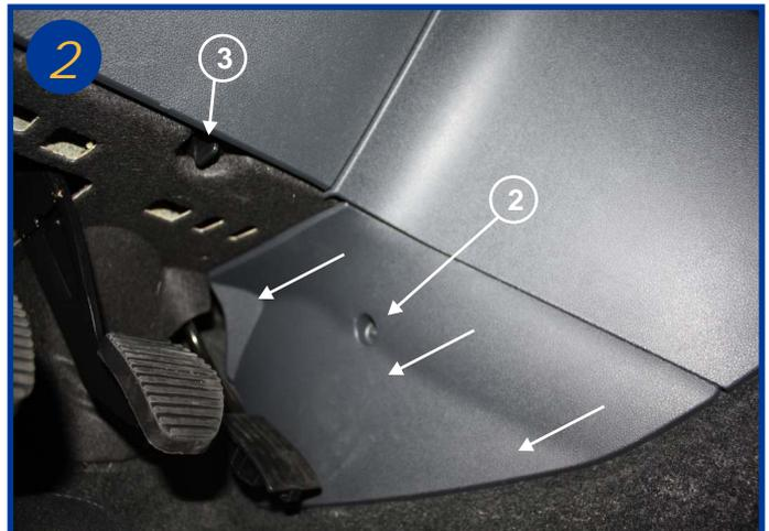
Dévisser la vis Torx (T20)(2) et reculer le carter vers le fond (voir flèche) et le retirer. Dévisser les 2 vis plastique (3) du carter souple sous la colonne de direction et le retirer également.
