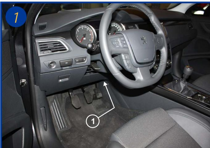
Le filtre d'habitacle est situé à l'intérieur du véhicule, côté conducteur, côté console à droite de la pédale d'accélérateur (1).
