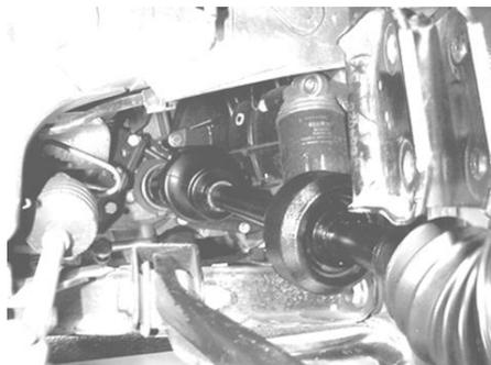
1) Insérer la transmission le plus horizontalement possible côté boîte (ou pont)
