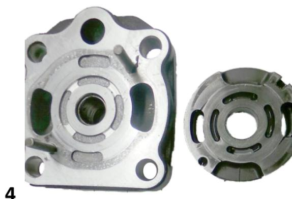
Lors de l'installation de cette pompe de direction, il est très fréquent de rencontrer un problème de mise en fonctionnement. Ce problème est identifié par le fonctionnement très bruyant de la pompe et la diminution par intermittence de l'assistance de direction hydraulique (Direction plus dure).
