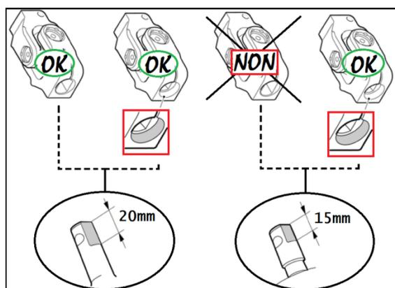
**!** Avant le montage de la nouvelle crémaillère de direction, **il est impératif de vérifier la version du pignon de la crémaillère que l'on vous fournit, ainsi que le croisillon de raccordement à la colonne de direction sur le véhicule.**
