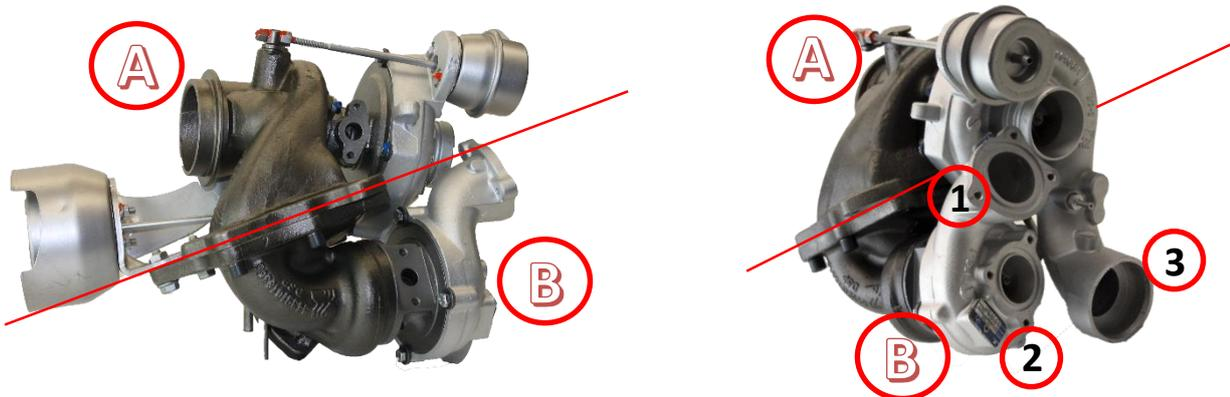
Ajoutez ensuite la conduite d'admission d'air (C), en fixant sur (B) les points (1) et (2) et en insérant dans (A) la partie (3), serrez les vis des fixations de l'admission (1) et (2), puis serrez complètement les vis reliant les turbos (A et B). Enfin procédez au montage sur le véhicule en veillant au bon positionnement des joints de raccord.
