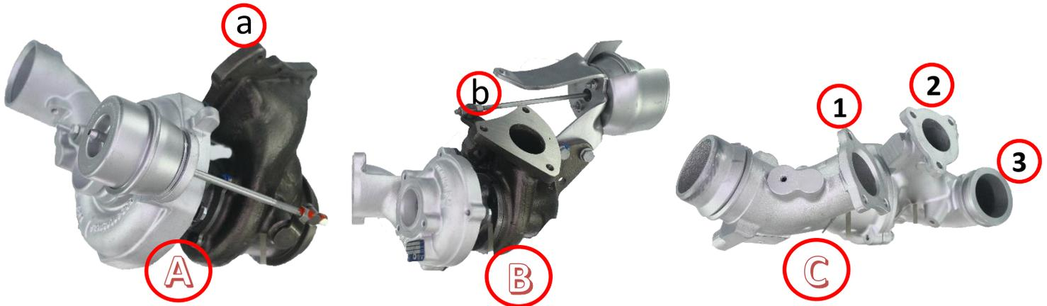
Assemblez en premier les parties (a) et (b) des 2 turbos (A et B), avec le joint et les vis fournis, sans serrer complètement les vis.
