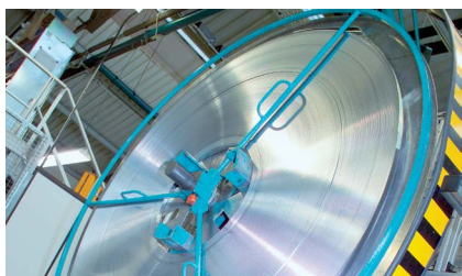
Исходный материал: высококачественные рабочие материалы трёхслойных подшипников.
