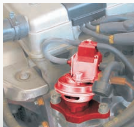
Elektryczny przetwornik ciśnienia (EDW) na zaworze upustowym w samochodzie Opel Astra (zaznaczony).
