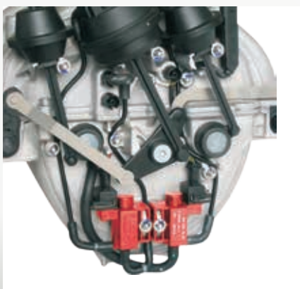
Elektropneumatyczny zawór przełączający (EUV) na rurze ssącej w Mercedesie Klasy C (zaznaczony).
