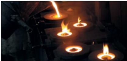
Fundição das peças brutas dos anéis de segmento (vazamento em coquilha)
