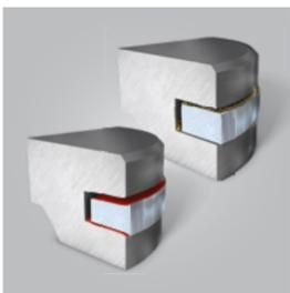
A sujeira que penetra na câmara de combustão é depositada nas ranhuras do anel provocando um desgaste abrasivo nas respectivas ranhuras e nos flancos do anel de segmento. Isso origina uma folga excessiva na altura do anel dificultando a entrada dos anéis de segmento nas ranhuras do anel. Os anéis torcem-se durante o funcionamento e começam a trepidar. Se os anéis sofrerem um elevado desgaste nos flancos, tal pode levar à sua ruptura.
