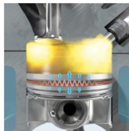
Devido às combustões detonantes ou autoignições ocorrem grandes picos de pressão no cilindro e uma grande carga mecânica nas peças. Os anéis de segmento começam a trepidar e podem quebrar. No caso de anéis revestidos com molibdênio a camada de molibdênio pode quebrar.
