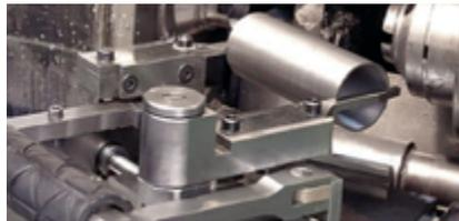
Lixamento da superfície de deslizamento do anel de segmento
