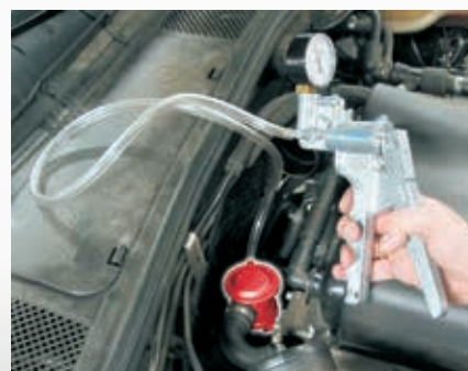
Snadná kontrola pneumatických konstrukčních dílů jednoduchými nástroji.
