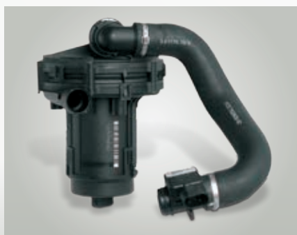
Sekundární vzduch je vefukován vysoceotáčkovým čerpadlem sekundárního vzduchu.
