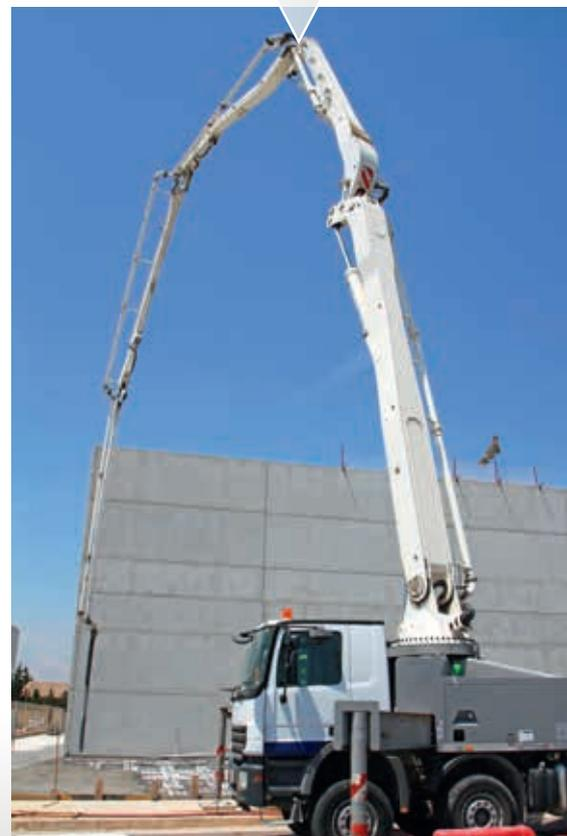
Mât distributeur en béton
