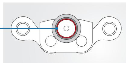
Supporti nei dispositivi di trascinamento di carrelli elevatori per magazzino a camere alte con boccole a strisciamento Permaglide® della forma costruttiva PAS ... P200
